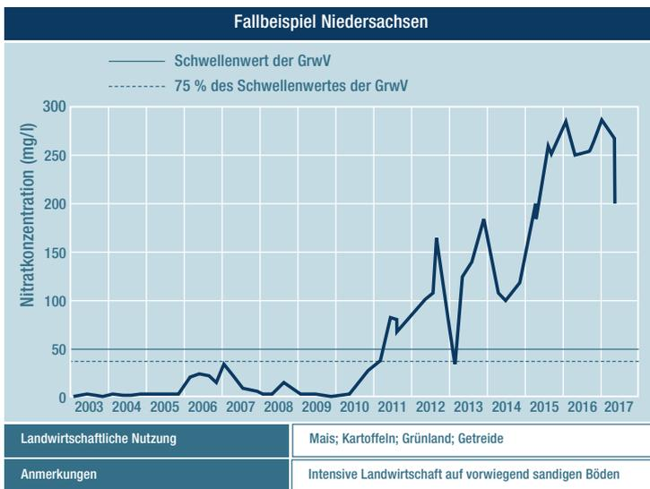
Abb. 3: Vorfeldmessstelle mit steigendem, extrem hohem Nitratgehalt
