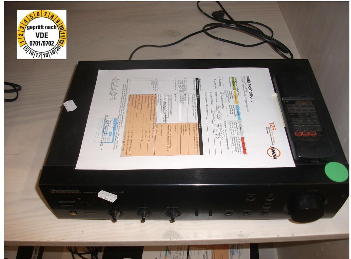
Jedes Elektrogerät wird mit einem Prüfprotokoll und einer Prüfplakette versehen.
