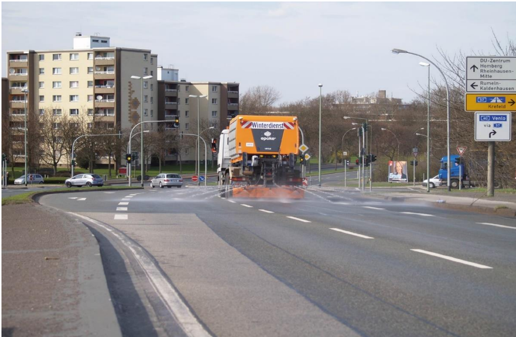
[Bild: Vorbeugende Streuung mit Salzlösung kann die ausgebrachten Salzmengen erheblich verringern und damit die Nachhaltigkeit optimieren [Bild: Epoke]]
