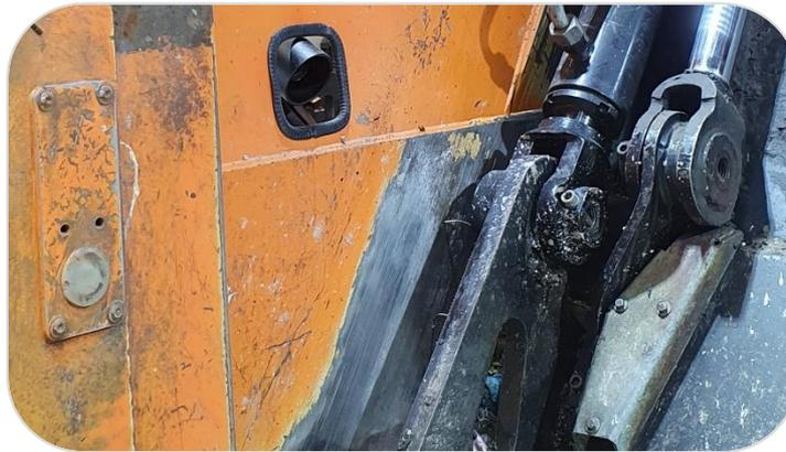
Position der linken KI-Kamera von innen, hier am Pressplattenfahrzeug, auch am Drehtrommelfahrzeug bereits realisiert
