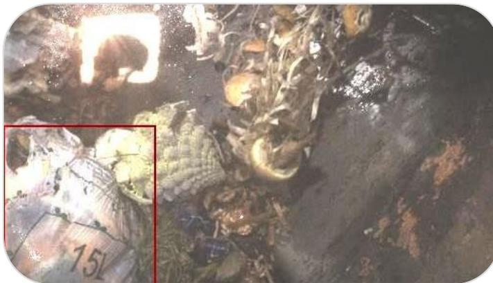
Ab Herbst 2025 wird das c-detect-System dieses Piktogramm erkennen und somit eine weitere Störstoffklasse (BAW-Beutel) detektieren.
