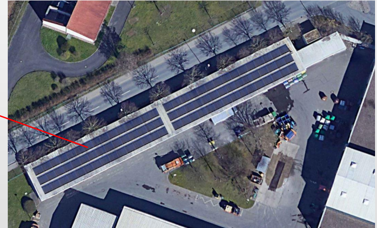
Solarthermieanlage: Fahrzeughalle neben Heizzentrale; ca. 700m 2
