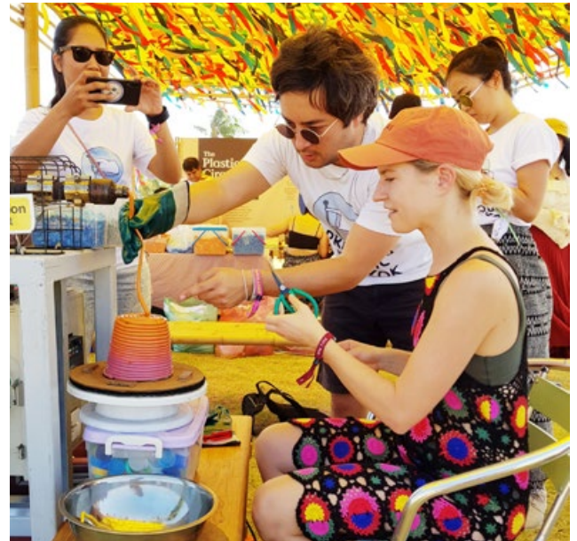
In der Zentrale von Precious Plastic Bangkok werden aus Schraubverschlüssen von PET-Flaschen mit einfachen Maschinen bunte Schalen, Lampenschirme und Blumentöpfe hergestellt. © Precious Plastic Bangkok
