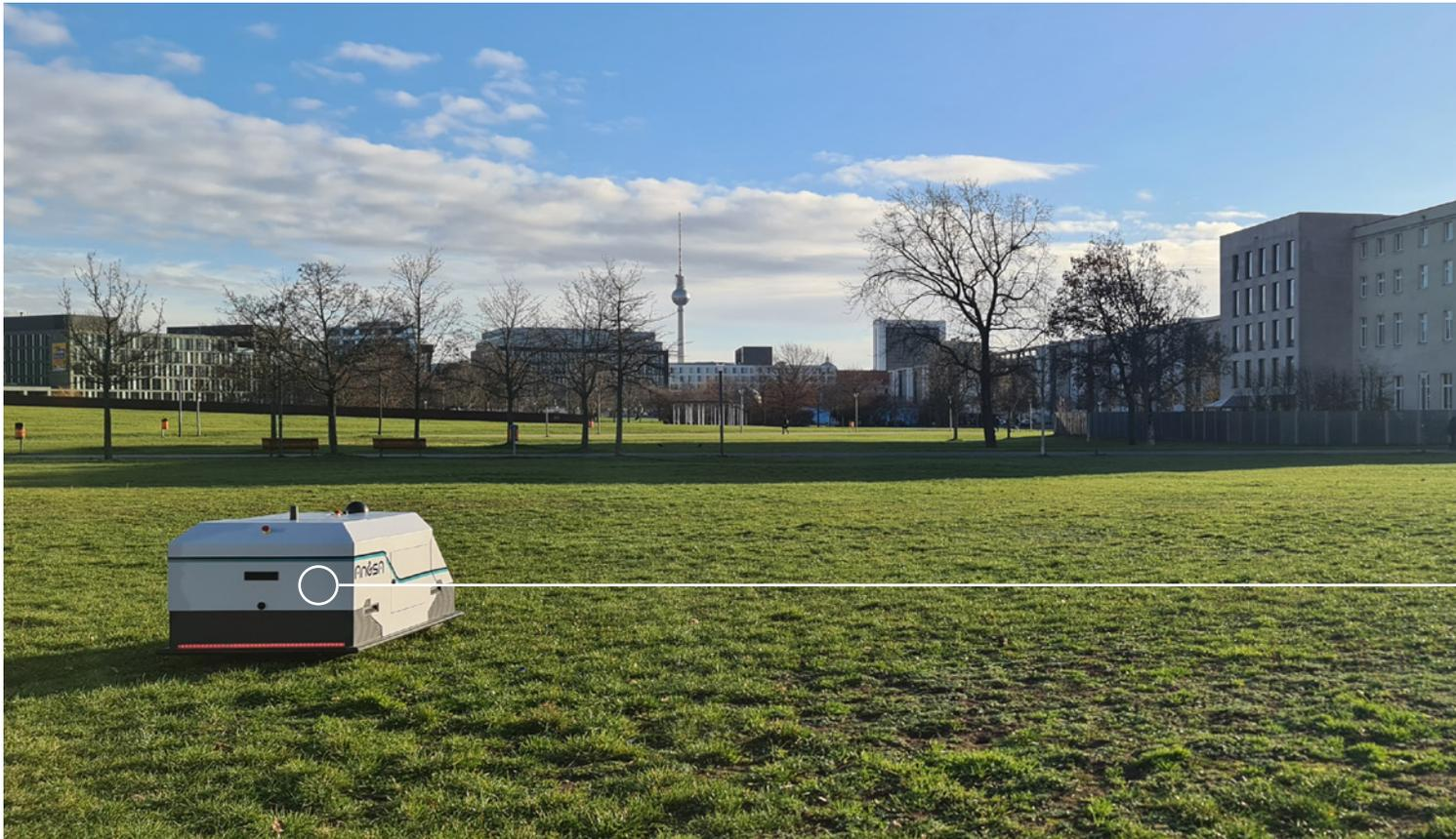
Der Angsa-Reinigungsroboter ist ein autonom fahrendes Reinigungsgerät.
