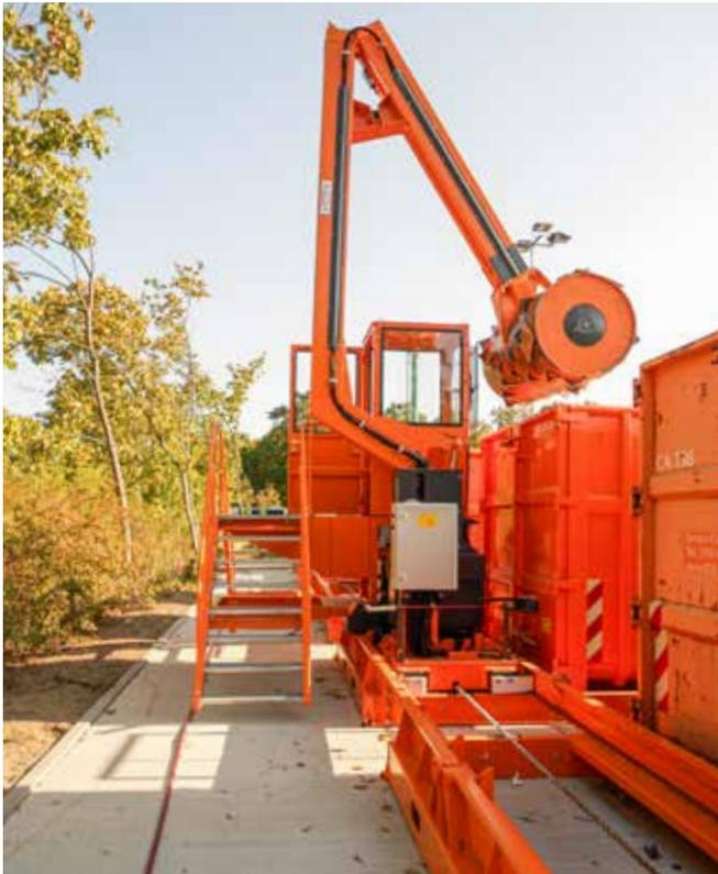
Abbildung 18: Rollpacker auf Verschiebeanlage
