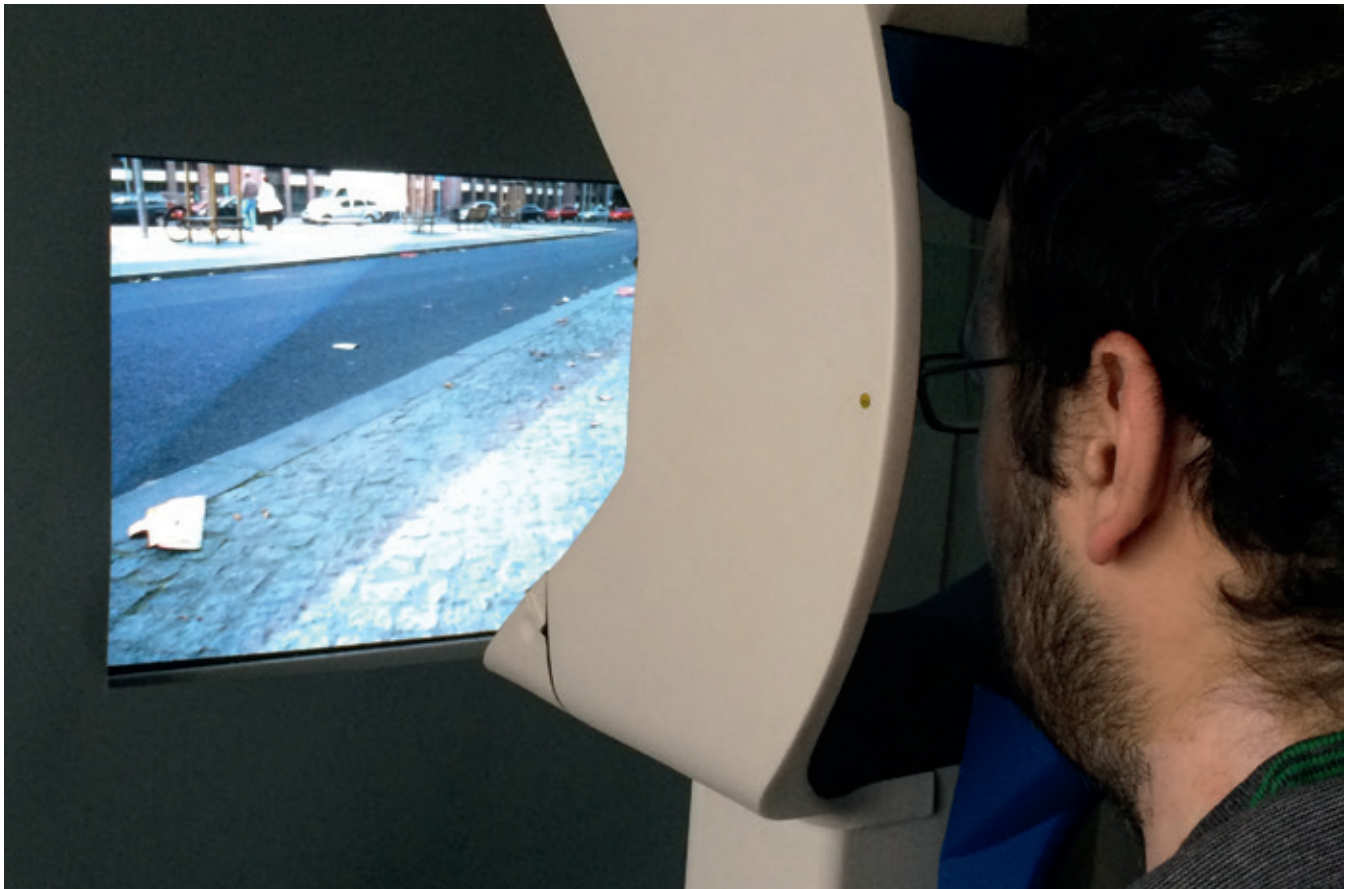
Abbildung 6: Versuchssituation eines Probanden mit Kopfstütze und integrierter Kamera bei der Blickbewegungsmessung; Bildschirm zur Reizapplikation und Tastatur zur Antwortregistrierung
